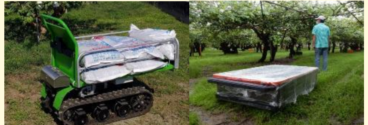
高雄區農業改良場 & 郡野公司共同研發 電動智能跟隨農地搬運機（履帶/輪式）
